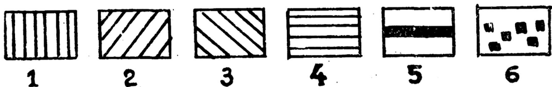
Рис. 11. Бокибойтепа. Шурф 4: 1—паховая стена; 2—кирпичная стена; 3—заполнение из строительного материала; 4—рыхлое заполнение с обломками пахсы и кирпича; 5—уровень пола; 6—вкрапления угля
