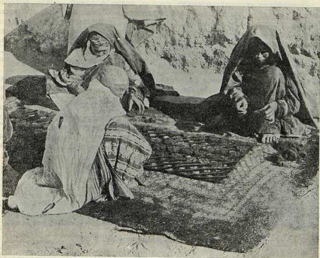
Рис. 2. Подготовка кошмы к катанию. Выкладывание увора.
