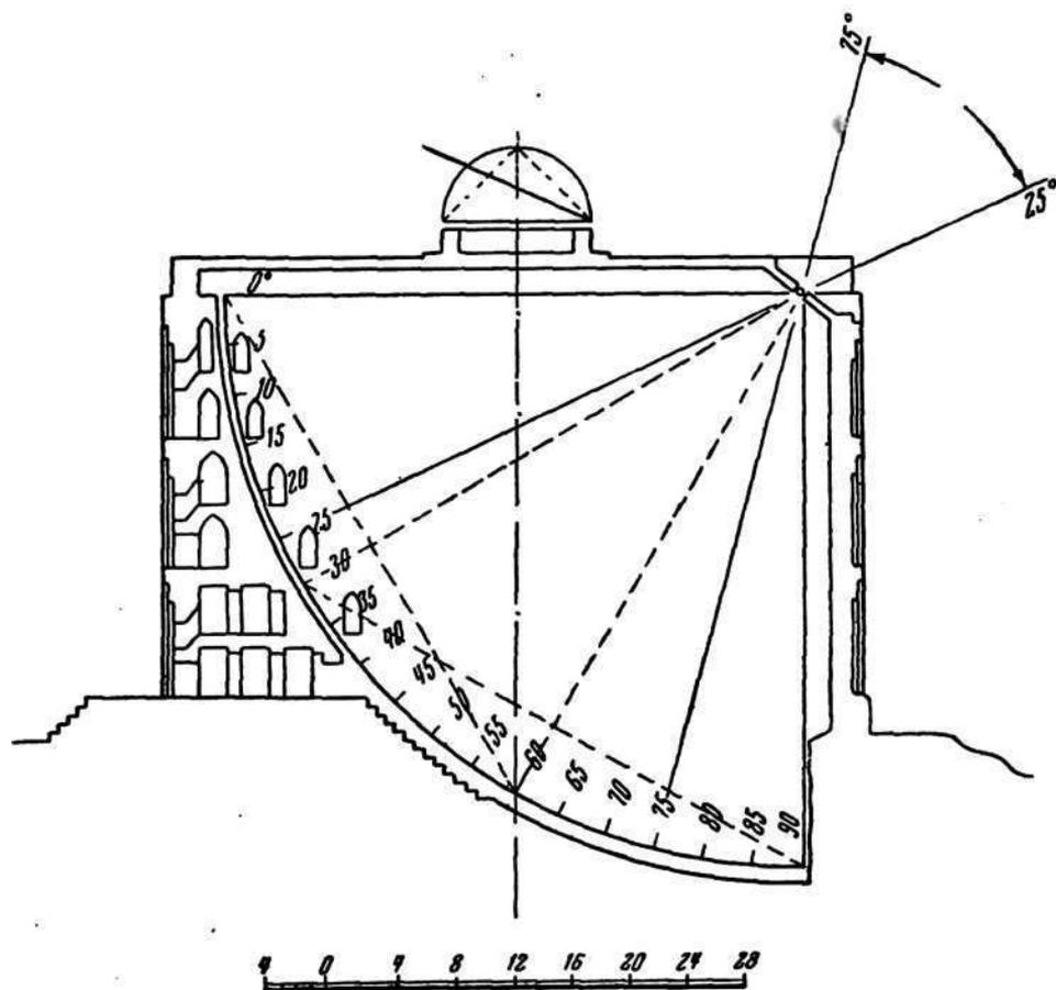
Рис. 44. Обсерватория Улугбека. Разрез север — юг.
