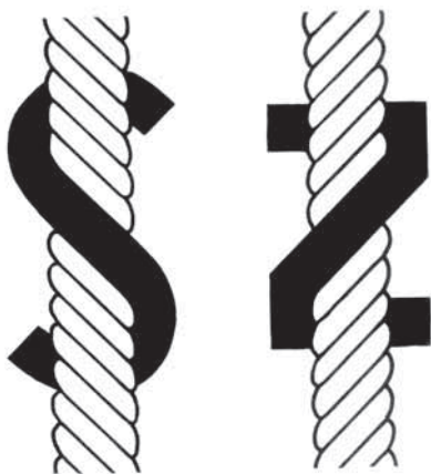
Рис. 29. Схема крутки нитей S и Z. Рисунок автора
