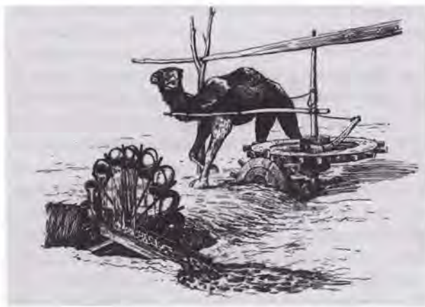
Старинное водоподъемное сооружение чигирь. Хорезм. XIX в.
