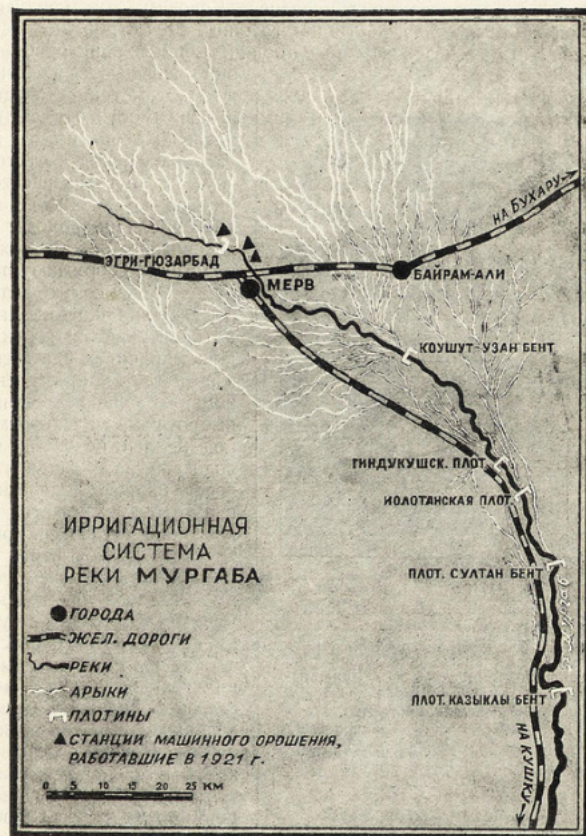
Р. Мургаб орошает Мервский оазис—один из древнейших в Средней Азии (Древняя Маргиана). Фотография четко показывает «ирригационный веер» каналов, выведенных из реки и к северу за полотном средне-азиатской железной дороги иссякающих в песках
