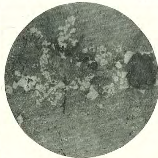
Рис. 2. Сrostки кристаллов куприта в шлаковой массе. Обр. № 18, \times 90 .
