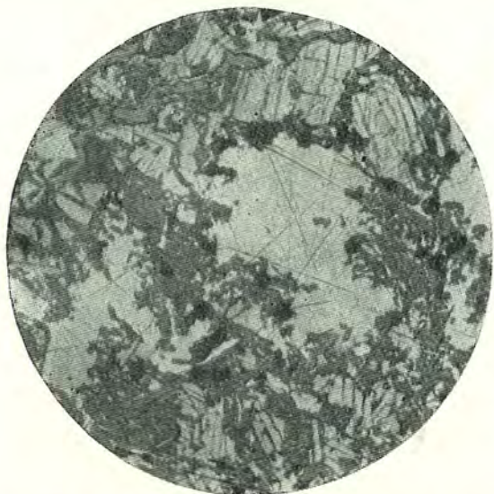
Рис. 6. Руда, состоящая из вкрапленностей халькозина (гладкие зерна) и ковеллина (зерна со штриховкой). Обр. № 1, \times 90 .
