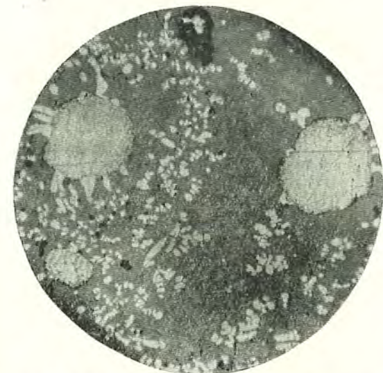
Рис. 4. Медь в крупных округлых включениях. Позднее вокруг меди в шлаковой массе отлагался куприт. Обр. № 9, \times 90 .
