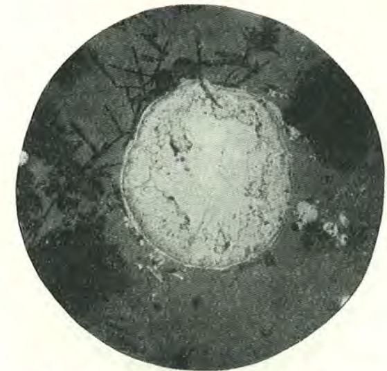
Рис. 5. Самородная медь замещается с краев купритом. Черные округлые пятна — пустоты от выпавших шарообразных включений меди. Обр. № 8, \times 90 .
